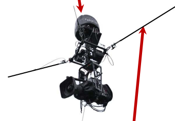
Cáblaí snáthoptaice clúdaithe le Kevlar
