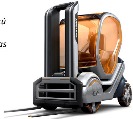
Forcardaitheoir coincheapa Doosan atá á chumhachtú le leictreachas
